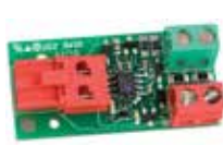
Шинный интерфейс XIB (для платы E045 или E024S с фотоэлементом без возмож- ности подключения к шине)
