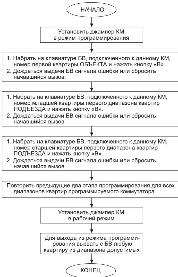
**Рис.6** Алгоритм программирования диапазона квартир коммутатора
