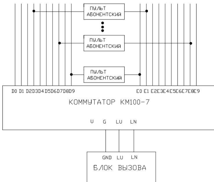
Рис.1 Вариант схемы подключения КМ100-7
