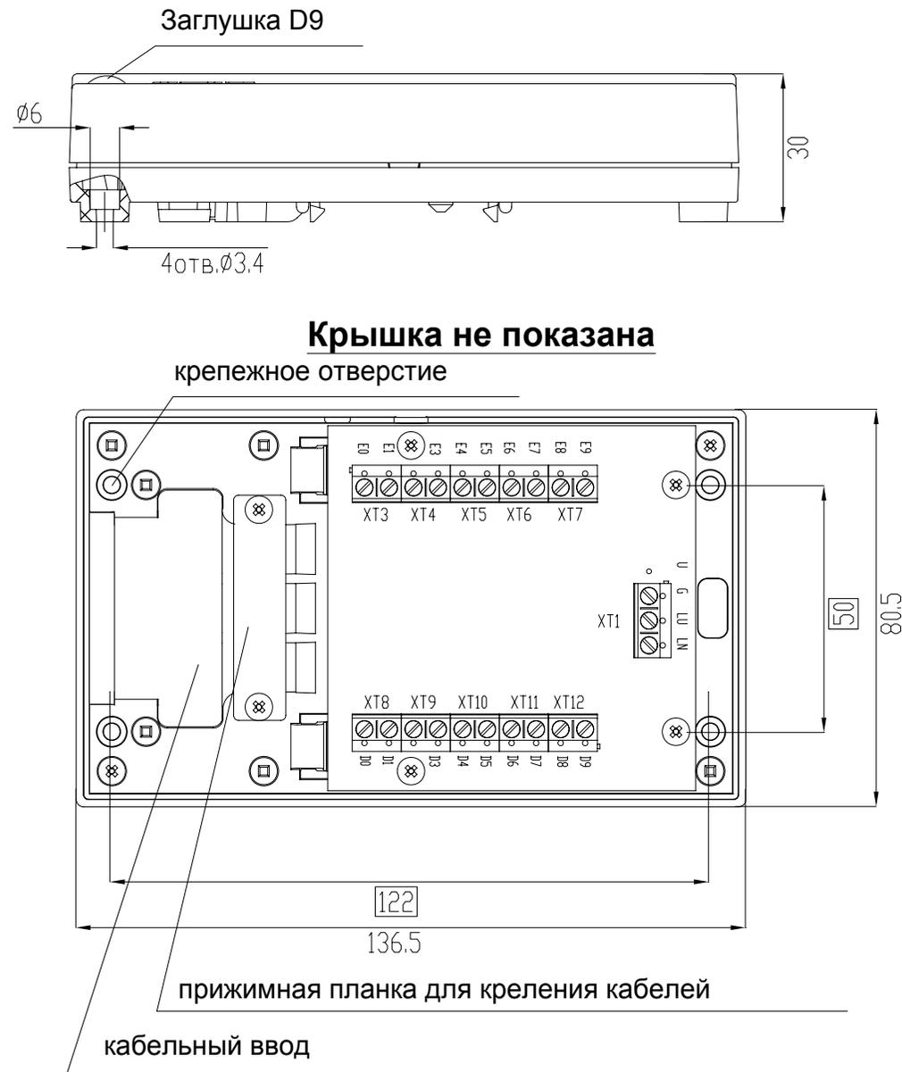
Рис. 2. Габаритные и установочные размеры КМ100-7
