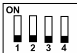
Рис.5 Переключатель конфигурации абонентской системы: 1 – согласование линии управления (используется при работе с коммутатором КМВ1.4-2.4(М)); 2 – управление функцией определения вызова (при работе ВМ без коммутатора КМВ1.4-2.4(М) – в положении «ON», с коммутатором – в положении «OFF»); 3 – адрес монитора в системе (используется при работе с коммутатором КМВ1.4-2.4(М)); 4 – адрес монитора в системе (при работе с коммутатором КМВ1.4-2.4(М)), либо тип подключаемого БВ (при работе без коммутатора КМВ1.4-2.4(М)).
