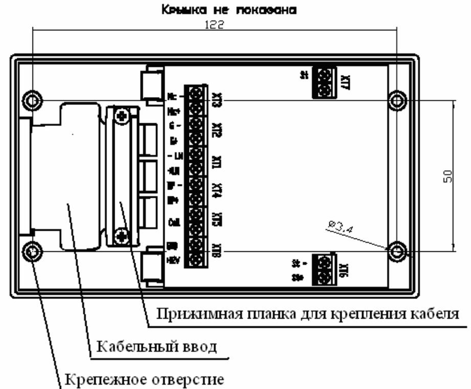
Рис.1 Внешний вид блока сопряжения ADC248-2
