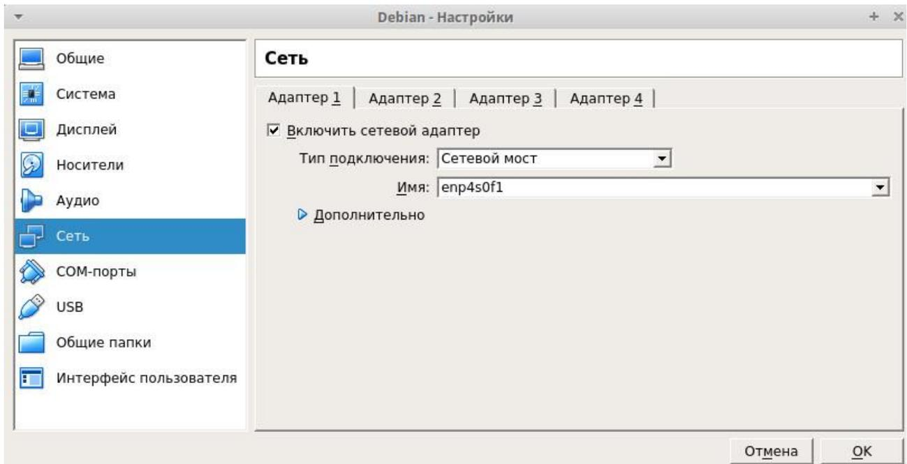
Выбираем сетевой мост, указываем интерфейс.
