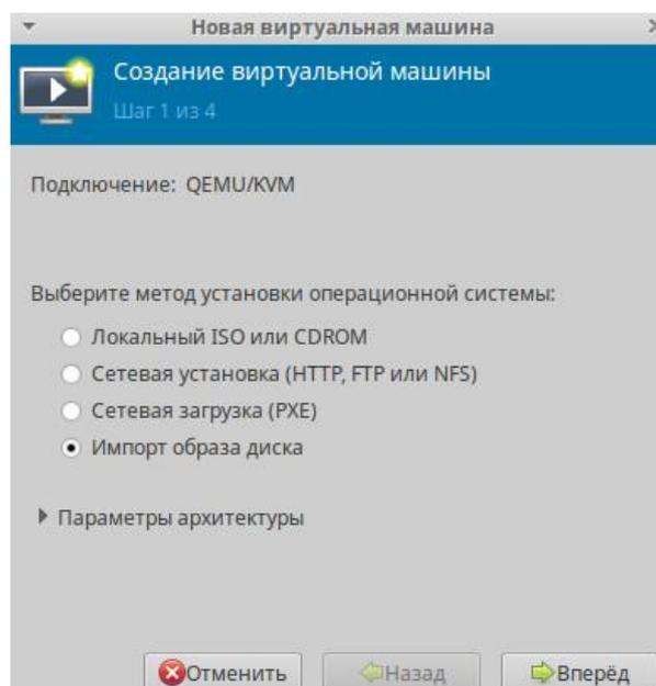
Выбираем образ виртуальной машины, создаем её.
