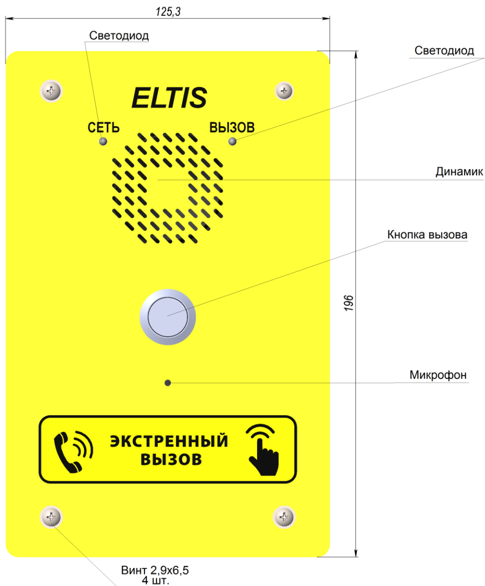
Рис.7 Внешний вид лицевой панели DP1-UF8M-01
